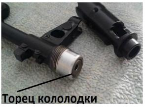
При полном накручивании ДТК-3T — подтянуть рукой с усилием, чтоб произошла фиксация штифтом, который на колодке АК74 в паз «гребенки».
